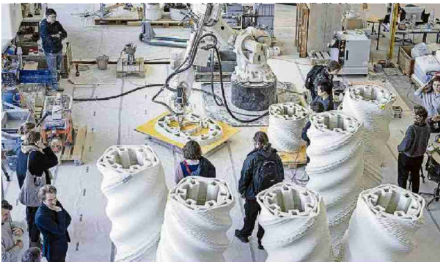
Druckbeginn: Die Säulen für den Weissen Turm von Mulegns werden auf dem ETH Campus Hönggerberg in Zürich von Robotern in einem 3D-Druckverfahren aus Beton gefertigt. Der Turm soll als begehbare Installation und Konzertraum dienen und eine Hommage an die Bündner Zuckerbäcker sein. Bilder: Michael Buholzer/Keystone
