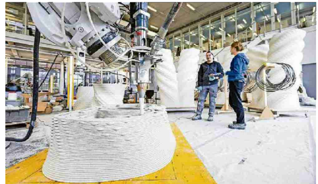
Druckbeginn: Die Säulen für den Weissen Turm von Mulegns werden auf dem ETH Campus Hönggerberg in Zürich von Robotern in einem 3D-Druckverfahren aus Beton gefertigt. Der Turm soll als begehbare Installation und Konzertraum dienen und eine Hommage an die Bündner Zuckerbäcker sein. Bilder: Michael Buholzer/Keystone
